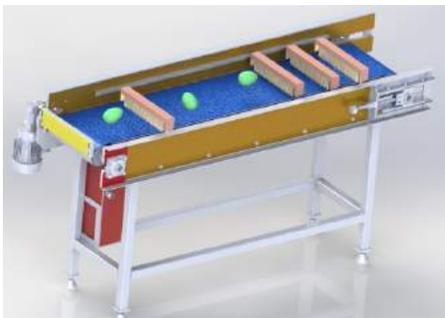
Fig. 6. Solución 2, máquina limpiadora compuesta por una banda transportadora liza y la limpieza lo realiza un conjunto de cepillos rectangulares al ser transportada la tuna por la banda transportadora.
