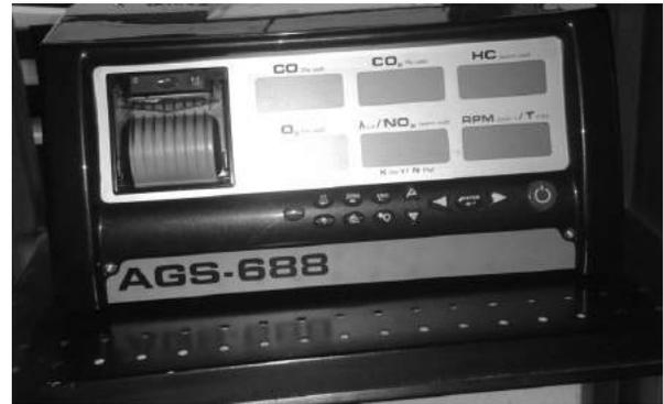
Figura 5 Analizador de gases
