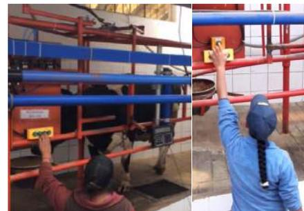
Figura 19: Apertura y cierre de puertas mediante la fuerza neumática controlado por pulsadores
