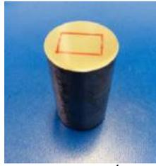
Fig. 2. Eje de acero AISI 1018. Área de escaneo de las inclusiones (10mm x 16mm)
