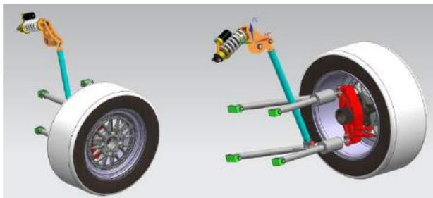
Figura 5. Ensamble total de la suspensión en NX. Fuente (Propia)
