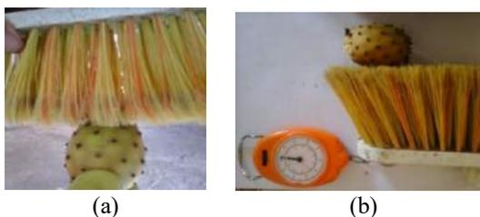
Fig. 8. (a) Ensayo de limpieza de la tuna para determinar la velocidad de limpieza, la velocidad se determina estableciendo una distancia de desplazamiento del cepillo constante y se mide el tiempo. (b) Ensayo para determinar la fuerza de fricción que es capaz de realizar la eliminación de espinas.
