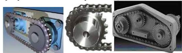
Figura 15. Ejemplos de trasmisiones por cadena.
