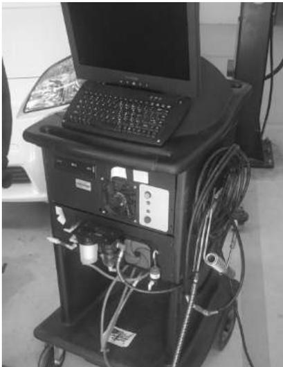
Figura 3 Opacímetro
