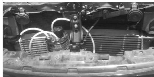
Figura 2 Instalación del generador de hidrógeno
