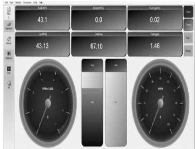
**Figura 6.** Valores al final de la prueba en carretera en condiciones híbrido estándar con el interfaz OBDWIZ
