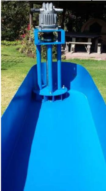
Fig. 2 Turbina de flujo axial
