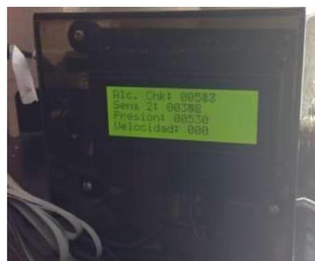
Figura 4. Módulo de control electrónico del alcoholímetro
