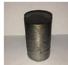
Fig. 1. Eje de acero AISI 1018. Diámetro 25 mm y altura 40 mm
