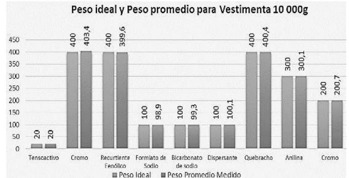
Fig. 10. Gráfica de barras con el peso ideal y el peso promedio de los químicos para Vestimenta con un peso de 10000g
