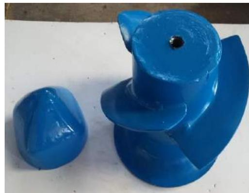
Fig. 9 Rotor de la turbina
