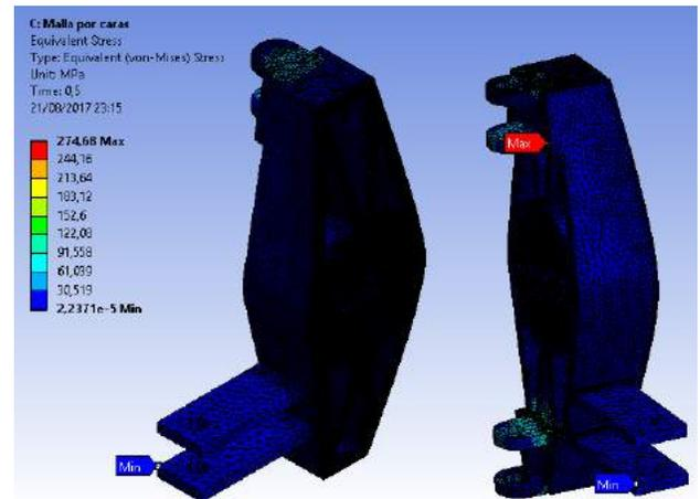
Figura 1713. Esfuerzo equivalente de Von Mises. Fuente (Propia).
