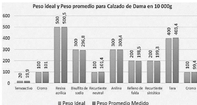
Fig. 11. Gráfica de barras con el peso ideal y el peso promedio de los químicos para Calzado de Dama con un peso de 10000g
