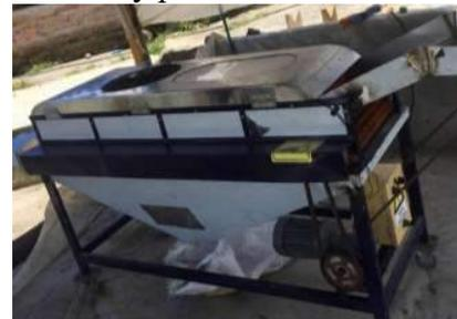
Fig. 17. Prototipo de máquina limpiadora de espinas de tuna.
