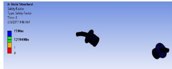
Fig. 20. Factor de seguridad del acople analizado con el software Ansys.
